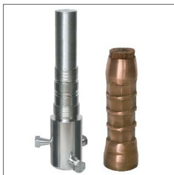
Capocorda Disponibili diversi modelli di capicorda -meccanico con coppia definita -a crimpare ottagonale o esagonale
